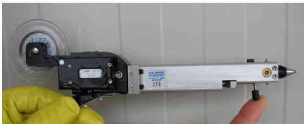
**Fig. 2:** Injectorul manual "multishot" folosit pentru implantarea mărcilor CWT
